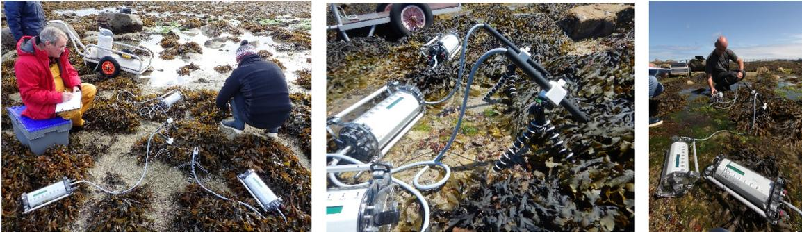
**Figure 2.2.1** Mesures de la fluorescence de la chlorophylle *a* en lumière modulée sur des communautés à *F. serratus*
