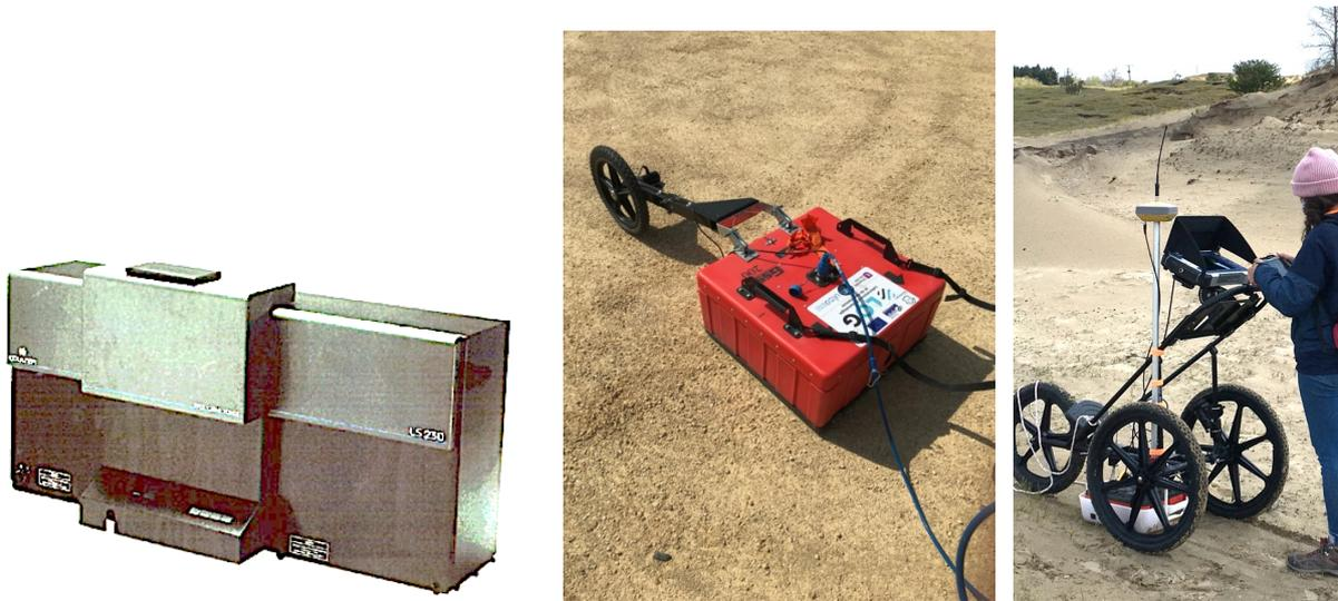
**Figure 5.2.1** Equipements acquis : le granulomètre laser (gauche), le géoradar (centre) et son antenne avec la roue codeuse.
