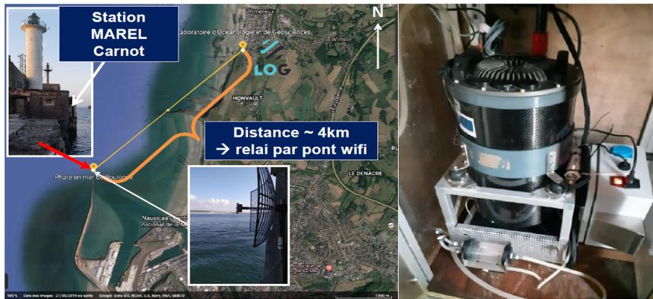
**Figure 1.1.9** Site d'échantillonnage (à gauche, Google Earth) et cytomètre en flux automatisé CytoSub (CytoBuoy b.v.) dans son caisson de protection (à droite).
