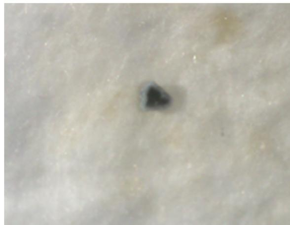
Figure 4.1.3. Mise en évidence d'une particule isolée par filtration des tissus après digestion.
