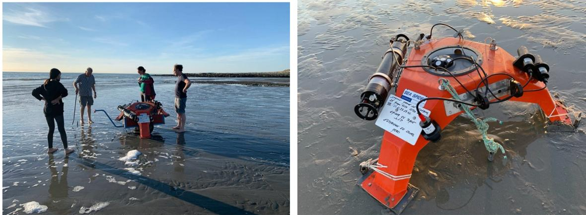
**Figure 1.4.1** Déploiement intertidal du signature 1000 sur un spider, avec d'autres instruments, en mai 2020.
